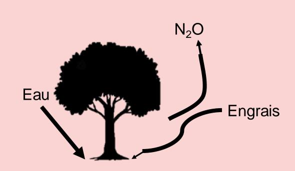
La quantité de biomasse nécessaire impose d'utiliser de grandes quantités d'engrais ce qui implique une forte production de N<sub>2</sub>O (qui possède un forçage radiatif 300 fois supérieur à celui du CO<sub>2</sub>). Il faut ajouter à cela que la BECCS nécessite beaucoup d'eau si l'on veut réduire la surface nécessaire.
