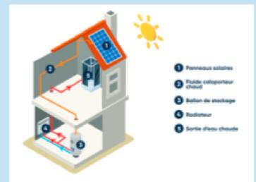
Le système solaire thermique couplé (SSC) relie des **panneaux solaires** à une **PAC** ou une **chaudière** pour assurer le chauffage.
