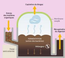
Le **biogaz** produit est injecté dans le réseau électricité/chauffage (en substitut au gaz fossile) ou converti en **biocarburant**
